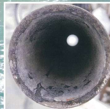
取替後 特殊処理配管 設置から2ヶ月経過
